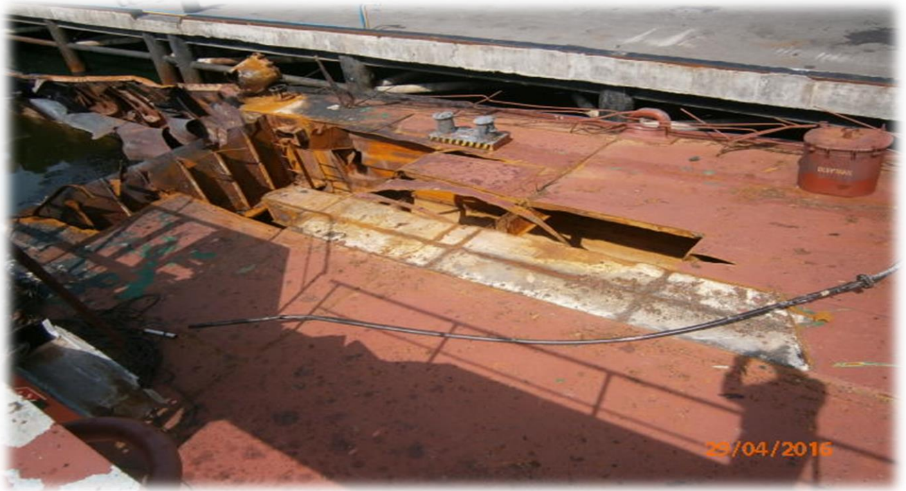
Şekil 19. Üst göyertenin zedelenmiş hissəsi
